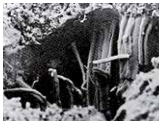
Zouten kristalliseren in de poriën van de KÖSTER restauratiepleister zonder schade aan te richten.
