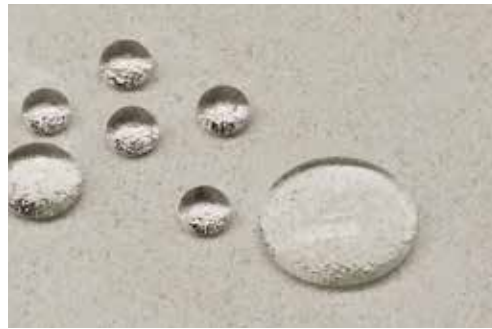
Hydrofoberen: het bouw materiaal waterafstotend maken.
